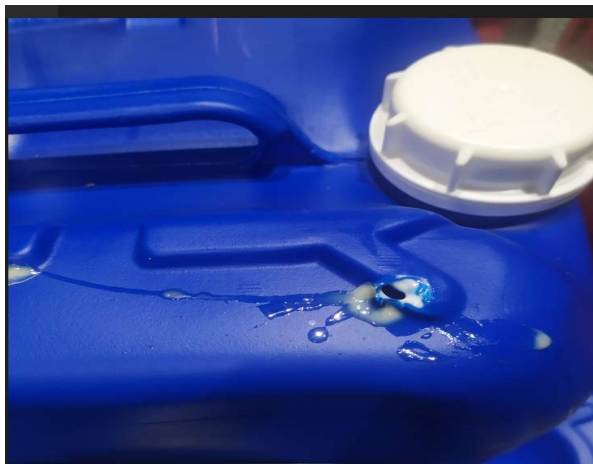
Повреждена упаковка, течь концентрата.
