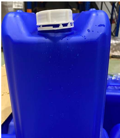
Нарушено страховочное кольцо.
