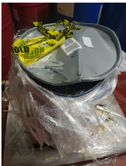
Замята бочка, вскрыта крышка.
